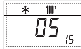
17. Zobrazení průtokoměru - průtoku TUV (např. 18 l / min a 0,3 l / min) nebo stavu tlakového spínače(zapnutí a vypnutí, v tomto pořadí)
