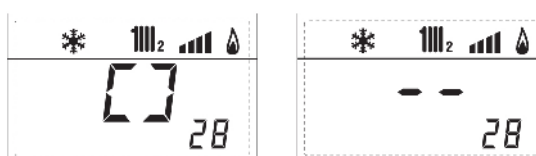
26. zobrazení otevření ventilu ZONA 2 (ON , OFF)
