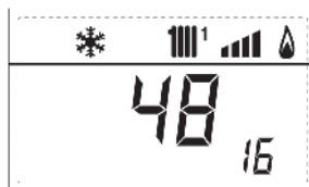
18. Zobrazení teploty NTC čidla na zóně 1 MIX
