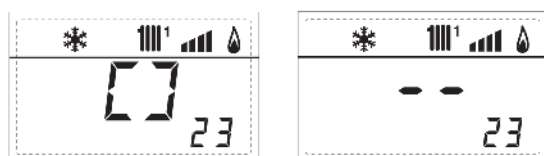
23. Zobrazení teploty NTC čidla na zóně 2 MIX (ON,OFF)
