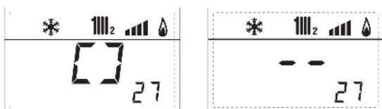
25. Zobrazení oběhového čerpadla zóny 2 (ON , OFF)
