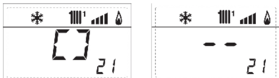
21. zobrazení otevření ventilu ZONA 1 (ON , OFF)
