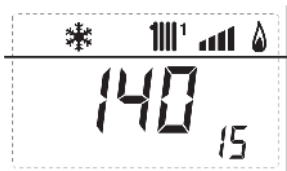
17. zobrazení měření průtoku TUV l/min (18 a 0,3) nebo sepnutí a ozepnutí průtokového spínače TUV
