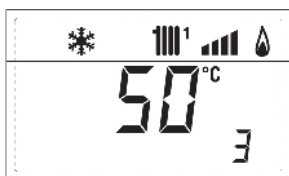
4. teplota na přídatném čidle (AUX) nebo na čidle TUV (SB)
