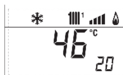
18. Zobrazení teploty NTC čidla na zóně 1 MIX
