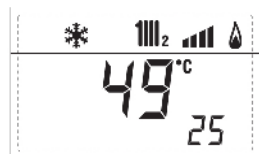
23. Zobrazení teploty NTC čidla na zóně 2 MIX (ON,OFF)
