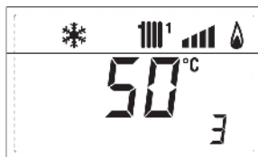
4. teplota na přídavném čidle (AUX nebo SB)
