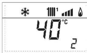
3. teplota TUV – NTC čidlo (SS)
