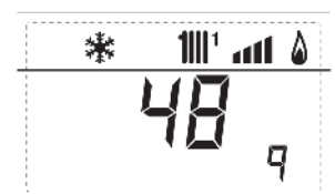
9. zobrazení otáček ventilátoru x 1000 (1850÷4800)
