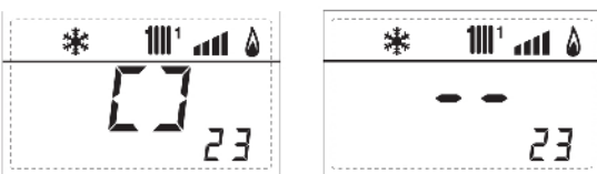
23. Zobrazení teploty NTC čidla na zóně 2 MIX
