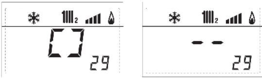
27. Zobrazení uzavření ventilu ZONA 2 (ON , OFF)
