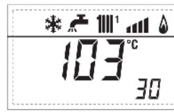
28. Zobrazení teploty solárních panelů – čidlo S1
