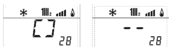
26. zobrazení otevření ventilu ZONA 2 (ON , OFF)
