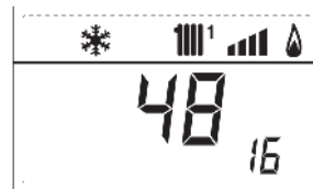
18. Zobrazení teploty NTC čidla na zóně 1 MIX
