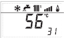
31. zobrazení relé R1 na solárním okruhu (INSOL)
