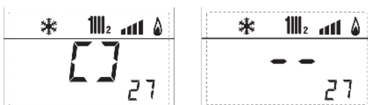
25. Zobrazení oběhového čerpadla zóny 2 (ON , OFF)
