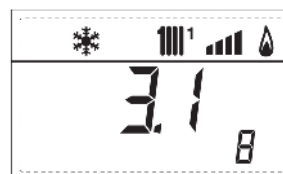
9. zobrazení otáček ventilátoru x 1000 (1850÷4800)
