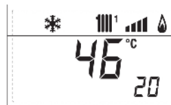
18. Zobrazení teploty NTC čidla na zóně 1 MIX
