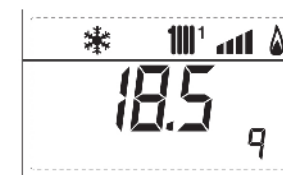
9. zobrazení otáček ventilátoru x 1000 (1850÷4800)
