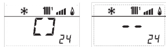
22. Zobrazení uzavření ventilu ZONA 1 (ON , OFF)
