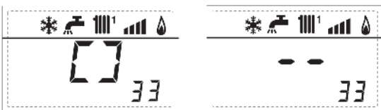
33. zobrazení relé R1 na solárním okruhu (INSOL)
