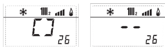
26. zobrazení otevření ventilu ZONA 2 (ON , OFF)
