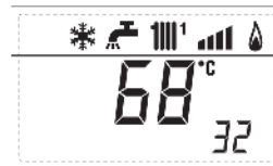
32. zobrazení relé R2 na solárním okruhu (INSOL)
