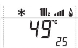
25. Zobrazení oběhového čerpadla zóny 2 (ON , OFF)
